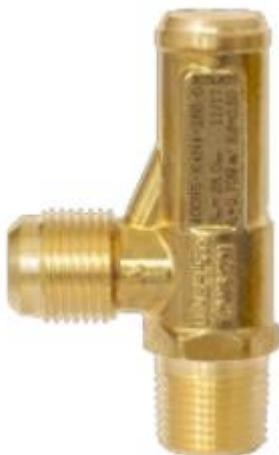
**Клапан предохранительный серии 40095, DN 9,5; резьба вх/вых: 1/2" NPT/ 5/8" SAE, 28 бар**
