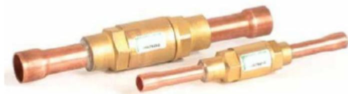
**Прямоточные обратные клапаны** устанавливаются в жидкостных линиях, линиях всасывания и в трубопроводах горячего газа холодильных установок и систем кондиционирования воздуха. Клапаны гарантируют движение потока хладагента только в заданном направлении.
